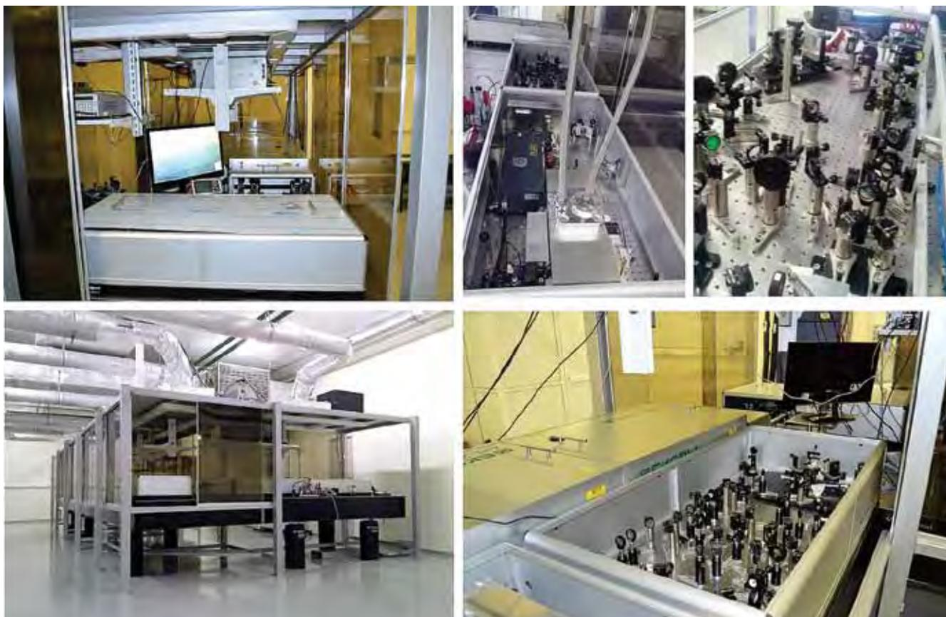
Рис. 1. Источник мощных сверхкоротких импульсов в среднем ИК-диапазоне. Центральная длина волны излучения 3,9 мкм, минимальная длительность импульсов 90 фс. Максимальная энергия импульсов до сжатия 50 мДж. Фотографии сделаны в лаборатории Российского квантового центра и МГУ имени М.В. Ломоносова
